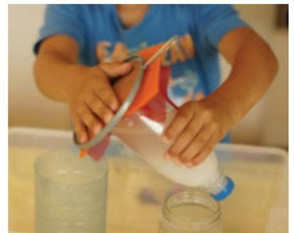
Durch langsames Öffnen des Drehverschlusses rinnt das Wasser in den Becher, die Zellstofffasern werden vom Polyestertuch zurückgehalten.
