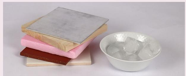
Abbildung 16: Materialien zum Testen der Wärmeleitfähigkeit © Wood Vision Lab
