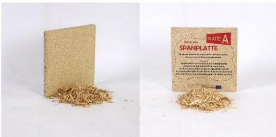
Abbildung 10: Spanplatte mit dem Ausgangsstoff kleine Holzspäne © Wood Vision Lab/proHolz Steiermark Werkstoffbox
