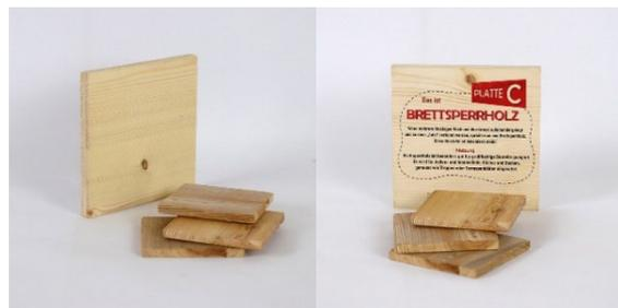
Abbildung 8: Brettsperrholzplatten mit dem Ausgangsmaterial dünnere Bretter ©Wood Vision Lab
