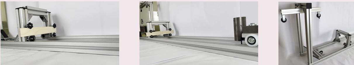
Abbildung 45: Befestigung der Barriere (1); Versuchsbahn (2), Versuchsfahrzeug (3) mit Aufprallkörper (4); Umlenkrollen (6). © Wood Vision Lab
