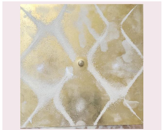
Abbildung 24 Messingplatte bei 505 Hz © Wood Vision Lab
