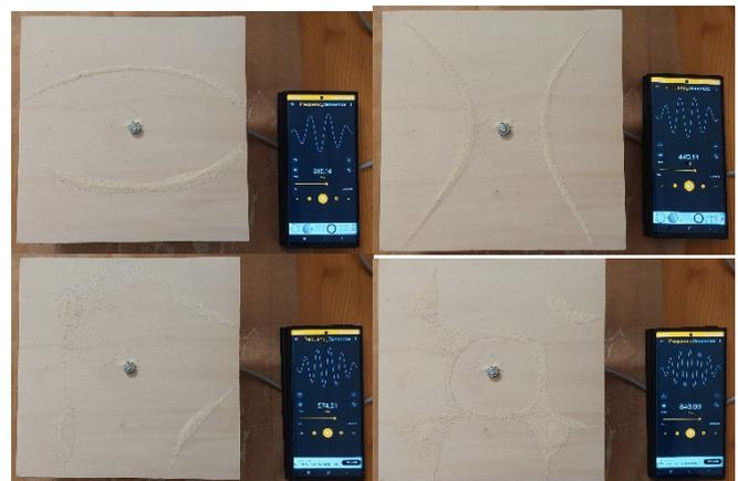
Abbildung 27: Pappelplatten bei 316,14 Hz, 445,14 Hz, 574,01 Hz und 840,90 Hz © Reichel
