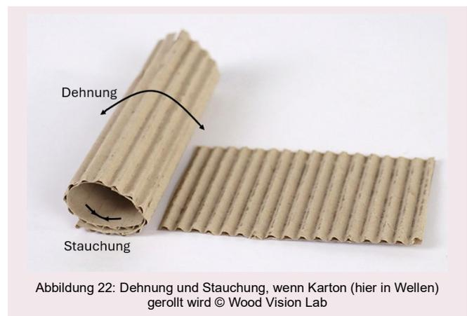
Abbildung 22: Dehnung und Stauchung, wenn Karton (hier in Wellen) gerollt wird © Wood Vision Lab
