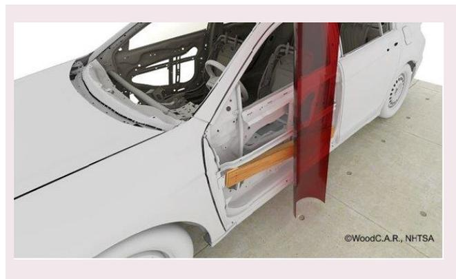
Abbildung 43: Eingebauter Seitenaufprallträger ©WoodC.A.R.
