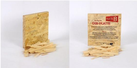
Abbildung 9: OSB-Platte mit dem Ausgangsstoff grobe Holzspäne © Wood Vision Lab/proHolz Steiermark Werkstoffbox
