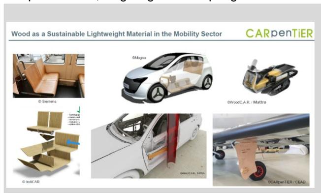
Abbildung 40: Übersicht über mögliche Holzleichtbaukomponenten in der Automobilbranche © CARpenTiER
