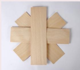
Abbildung 32: Sternförmig verleimte Furniere © Wood Vision Lab
