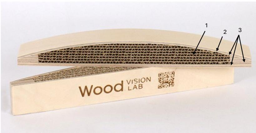
Abbildung 4: Seitenaufprallträger vom Wood Vision Lab
