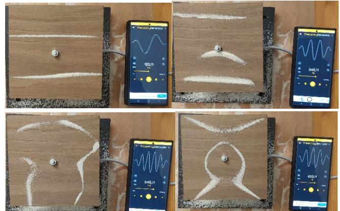
Abbildung 26: Eichenplatten bei 120,11 Hz, 340,11 Hz, 459,11 Hz und 648,11 Hz mit Grieß bestreut © Reichel
