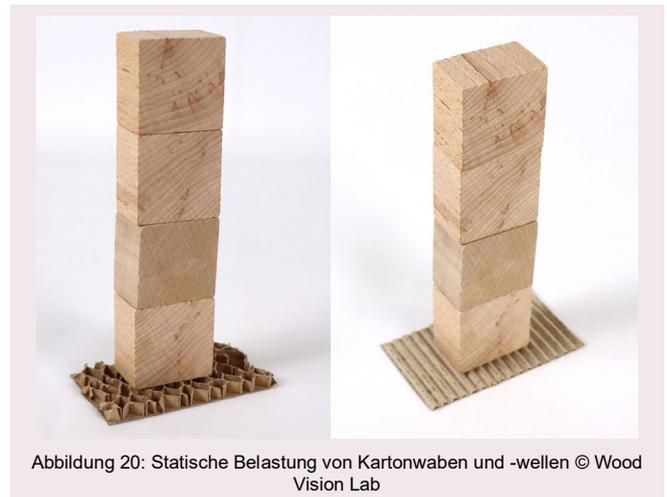
Abbildung 20: Statische Belastung von Kartonwaben und -wellen © Wood Vision Lab
