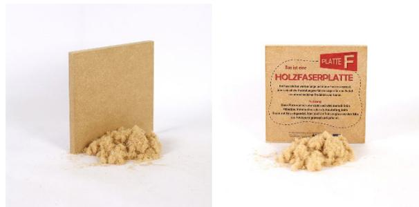
Abbildung 11: Holzfaserverplatte mit dem Ausgangsstoff feine Holzfasern © Wood Vision Lab/proHolz Steiermark Werkstoffbox
