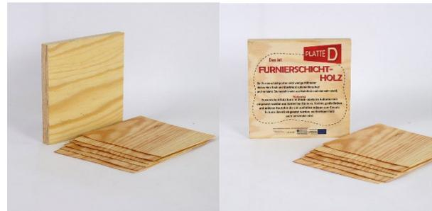
Abbildung 12: Furnierschichtplatte mit dem Ausgangsmaterial Furnier © Wood Vision Lab/proHolz Steiermark
