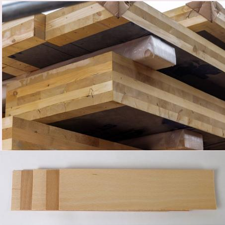
Abbildung 31: Brettspertholz besteht aus querverleimten Hölzern. Das kann ebenfalls mit Furnieren nachgestellt werden. ©Adobes Stock / proHolz Steiermark / © Wood Vision Lab
